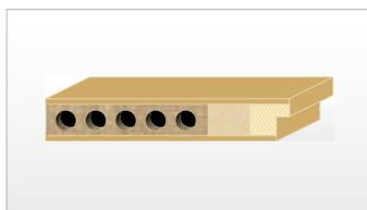
40 mm gefälztes Türblatt mit Innenlage Röhrenspanplatte, Normfalz und Überschlag kantig. Unverschießbar, ohne Schloss
