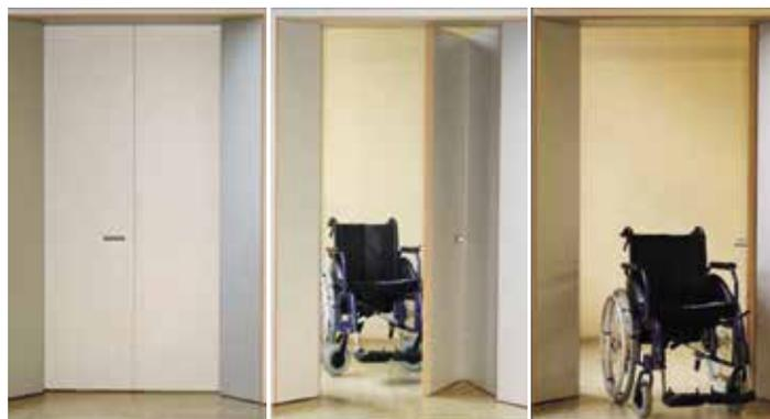
Ob mit Gehhilfe oder Rollstuhl – für Menschen mit eingeschränkter Mobilität ist das Passieren einer Tür mit erheblichem Aufwand und Hindernissen verbunden. Hierfür erleichtert die barrierefreie Knoll Raumspartür die Durchfahrt, ohne unnötiges Rangieren des Hilfsmittels, da sich der Schwenkbereich beim Öffnen der Tür halbiert.
